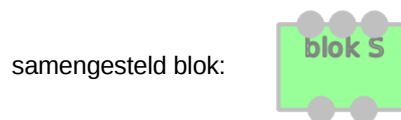
Figuur 5.5: De grafische voorstelling van een samengesteld blok met drie ingangen en twee uitgangen.
