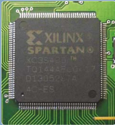
Figuur 5: Een Field Programmable Gate Array of FPGA van het merk Xilinx®. Met dit type van FPGA (Spartan3®) werden de testen in het onderzoek verricht.
